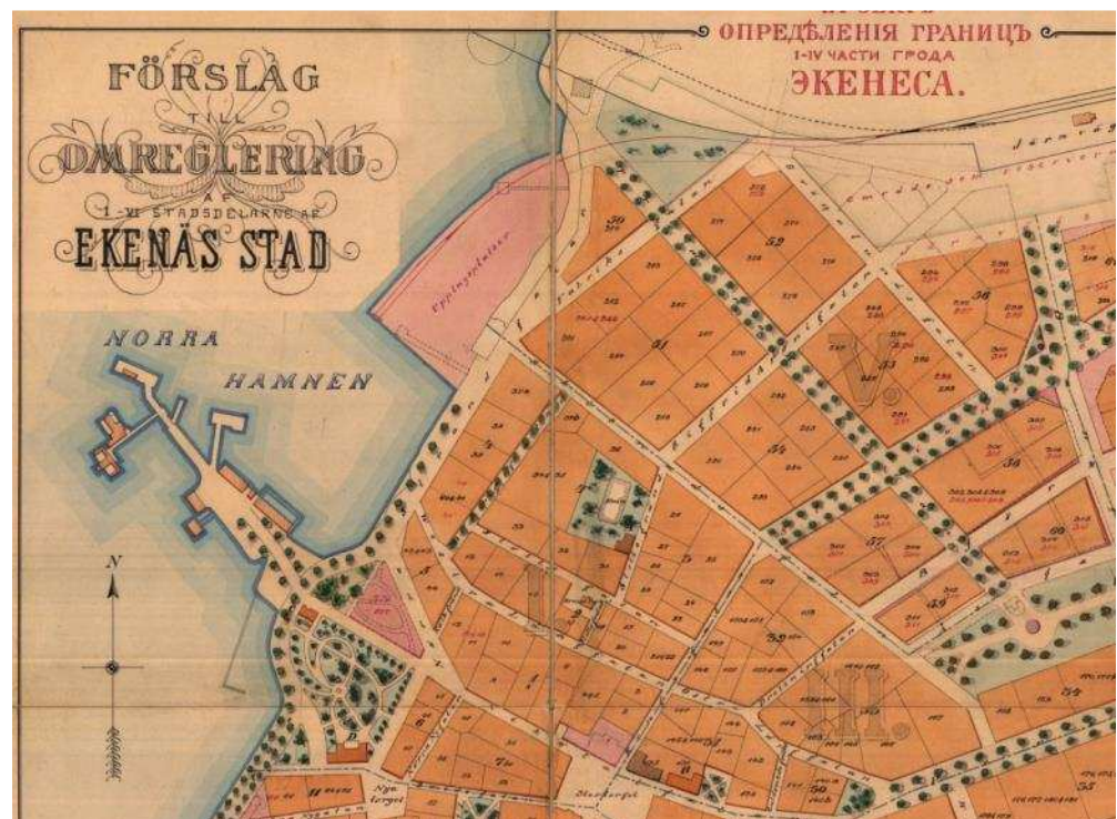
Ote asemakaavakartasta vuodelta 1911 (Lähde: Raaseporin teknisen viraston arkisto). Ehdotuksessa on esitetty uusi ratayhteys Pohjanlahden yli sekä pistoraideyhteys Pohjoissatamaan, joka edellyttää täyttöjä ranta-alueella ja vanhan kruunumakasiinin purkamista.
